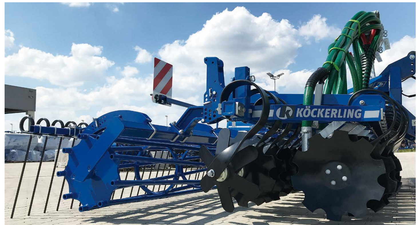
Rebell -classic- 600 mit Gülleverteiler und Rohrstabwalze
