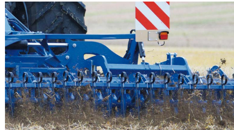
Rebell -classic- 600 mit Gülleverteiler und Rohrstabwalze
