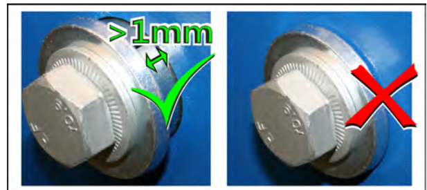
Abb. 3 Links: Korrekter Abstand > 1 mm, rechts: zu geringer Abstand
