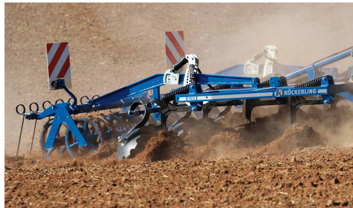
Trio 300 Med dobbelt STS valse Jævnnetallerkner og Stensikring
